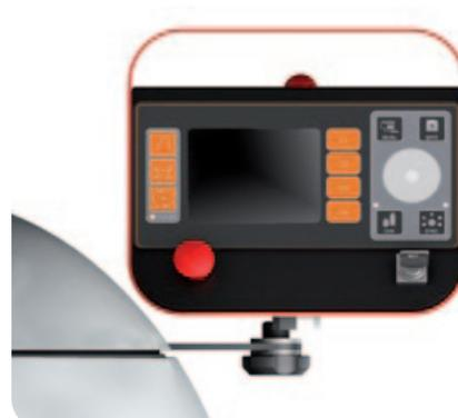
Ecran de programmation avec indication de la puissance, du temps d'une pulsation, de la fréquence de pulsation et des différents paramètres de fonctionnement. Le tir est commandé aux pieds par une pédale.
