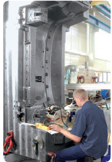
Rechargement dans un moule de 20 t. pour pare-chocs
