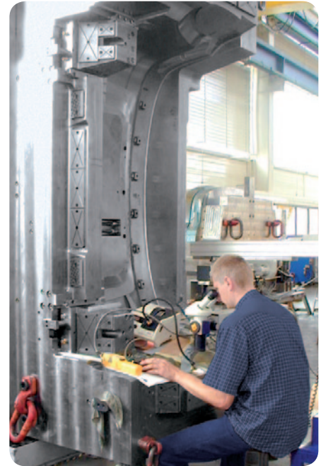
Bearbeitung einer 20t Spritzgußform für die Stoßstangen Produktion.
