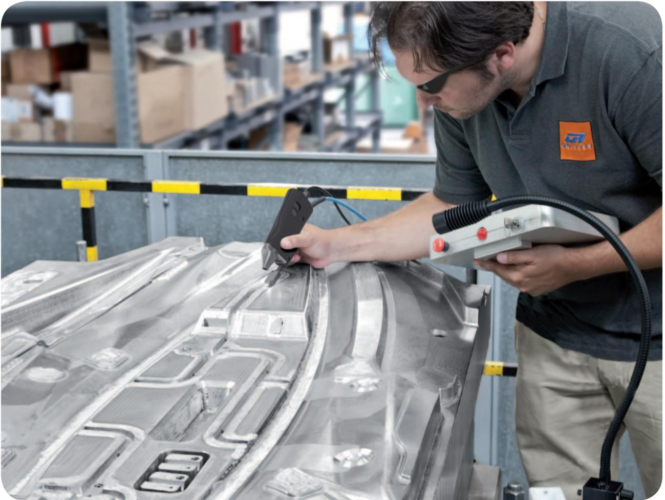
*Soudure de réparation sur un moule à préforme*
