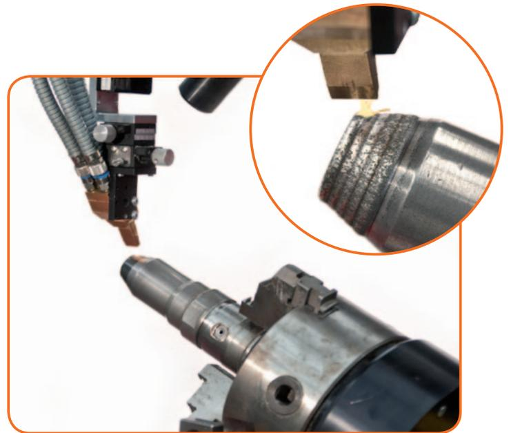
*Réparation du revêtement d'une buse d'injection par revêtement laser à poudre*
