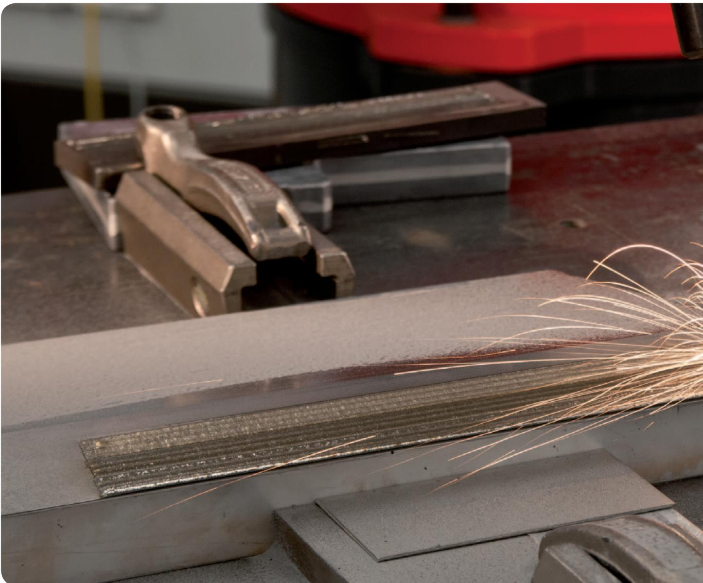
Application d'une couche de protection d'usure sur un couteau au moyen d'un revêtement laser par poudre
