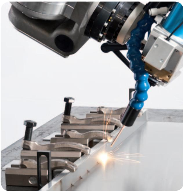
*Soudure laser des plaques de renforcement sur une plaque de couverture faite en acier inoxydable*
