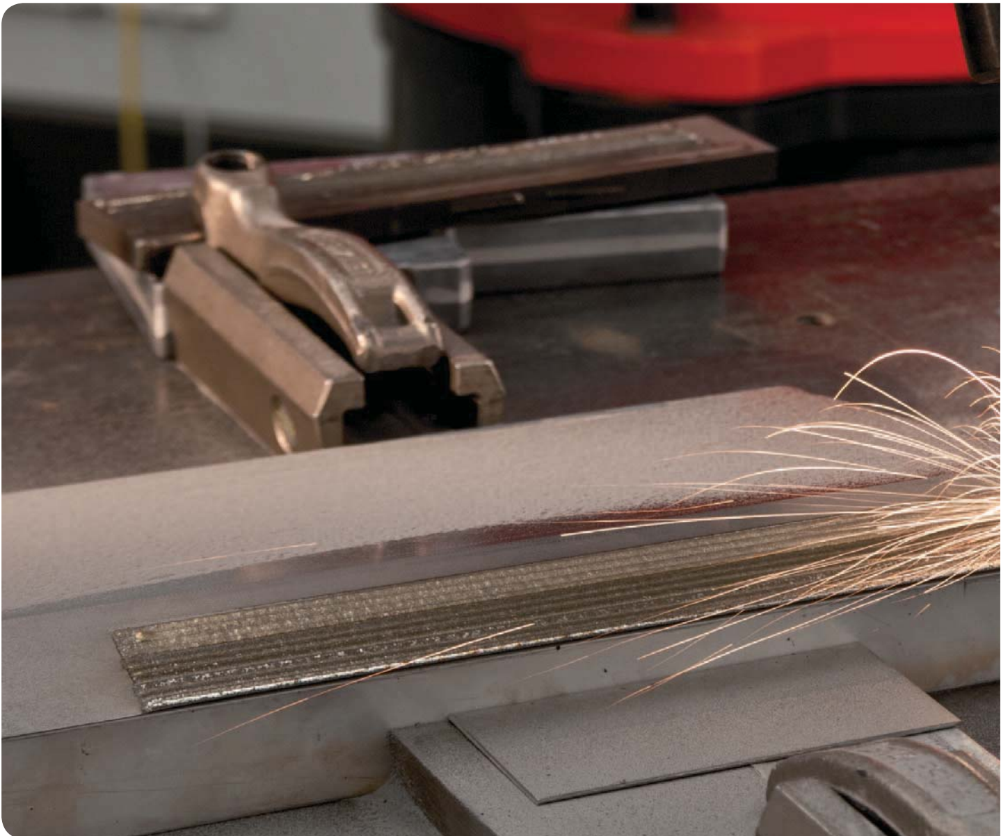
通过激光粉末熔敷将磨损防护层应用于刀具
