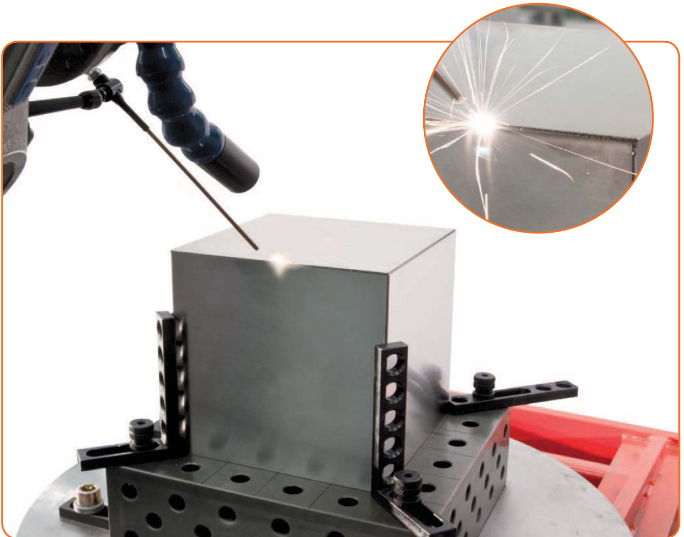
顾客样品生产. 不锈钢外壳的激光焊接
