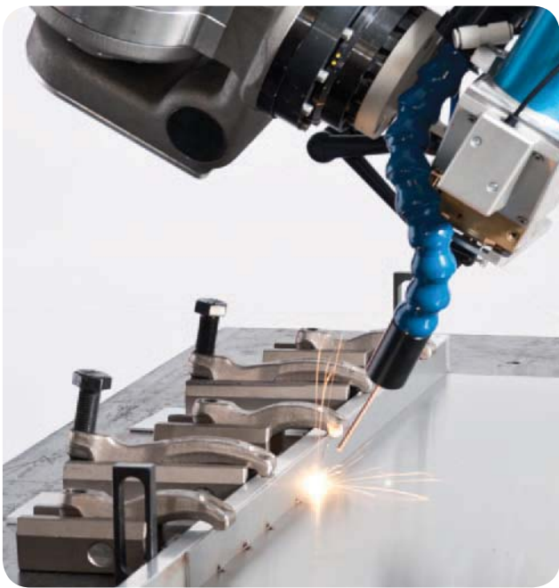
在不锈钢盖板上激光焊接加劲板
